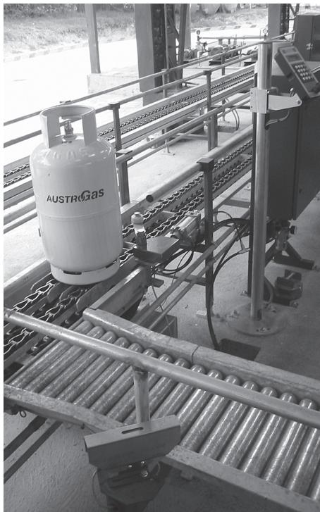
Рис. 3. Полностью автоматическая система контрольного взвешивания ECS, установленная на линии в цепном конвейере с роликовым конвейером для выведения некорректно заполненных баллонов
