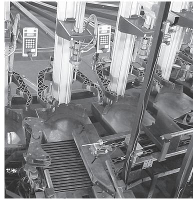
Рис. 6. Пункт радиального ввода, со-вмещенный с пунктом тангенциаль-ного вывода с «толкателем» баллонов на каждом заправочном аппарате (вариант компоновки — 4 С)
