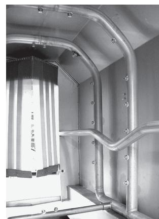
Рис. 3. Система труб со встроенными насадками, установленная на внутренней стороне моющего тоннеля
