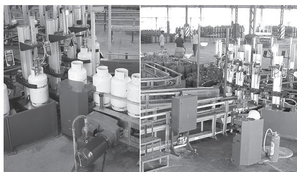
Рис. 5. Карусель с устройствами радиального ввода и вывода HRS
