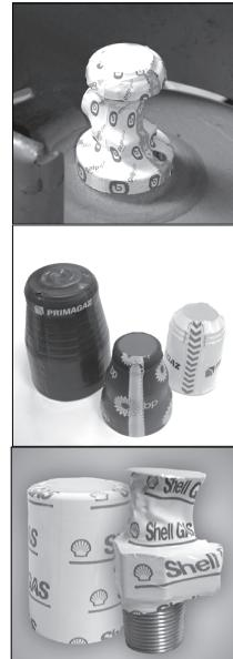
Рис. 1. Полнотью автоматическая система установки и примеры защитных термоусадочных колпачков
