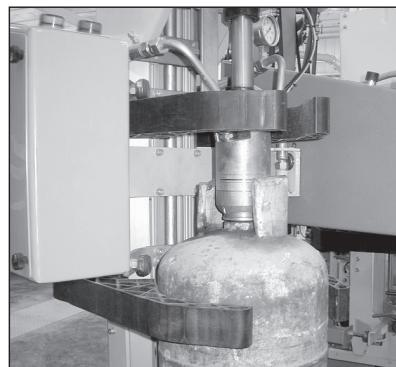
Рис. 4. Баллон, проходящий тестирование давлением на карусели
