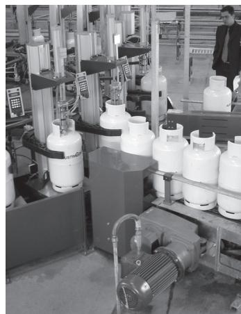
Рис. 3. Пункты ввода и вывода баллонов
