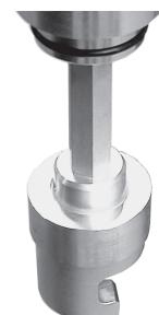
Рис. 1. Аппарат для замены клапанов PVS для установки в цепной конвейер
