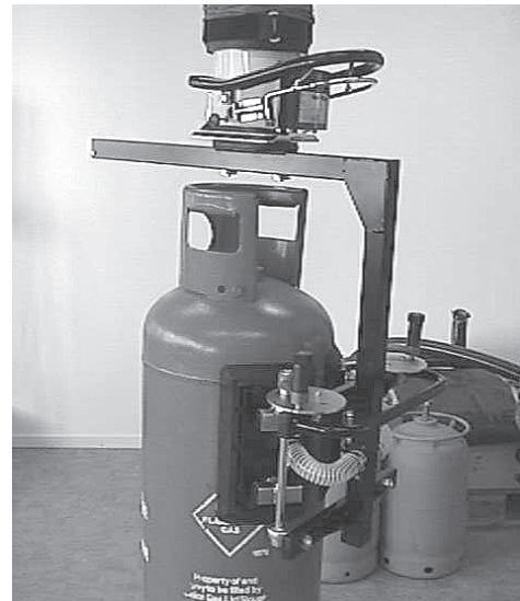
Рис. 5. Пример вакуумного подвесного устройства, установленного на подвесной рельсовой системе
