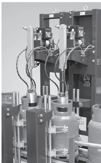
Рис. 3. Полностью автоматический детектор утечек ET-GD с двумя головками и с автоматической регулировкой высоты
