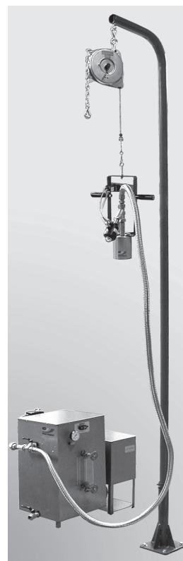
Рис. 3. Пневматическая термоусадочная машина SMS с ручным управлением для стационарной установки на полу
