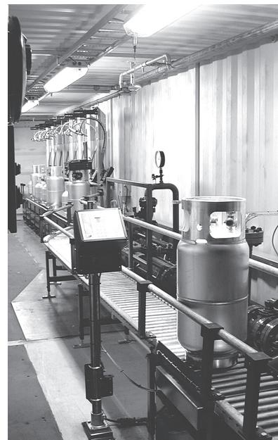
Рис. 2. Универсальные заправочные аппараты UFM в ряд на роликовом конвейере
