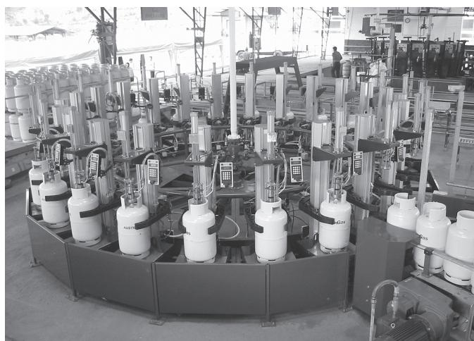
Рис. 2. Карусельная заправочная система на базе универсальной заправочной машины UFM
