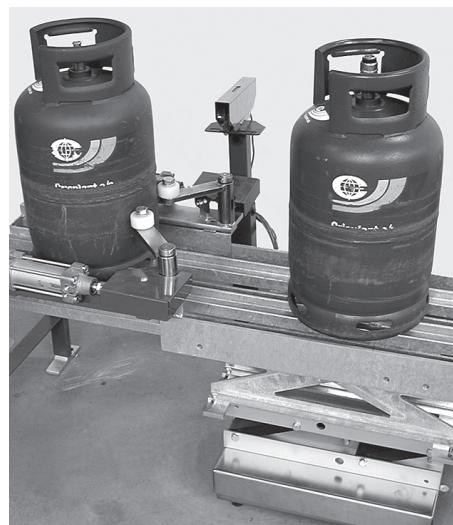
Рис. 2. Подробный вид установки для сбора данных на цепном конвейере (включая фотоэлемент) и подъемный стол
