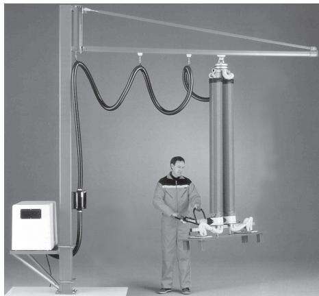
Рис. 2. Пример вакуумного подвесного устройства для погрузки/выгрузки
