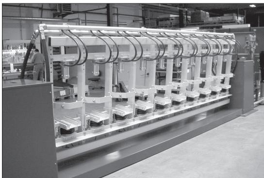
Рис. 3. Аппарат для проверки давлением PTL-10 на автономной раме
