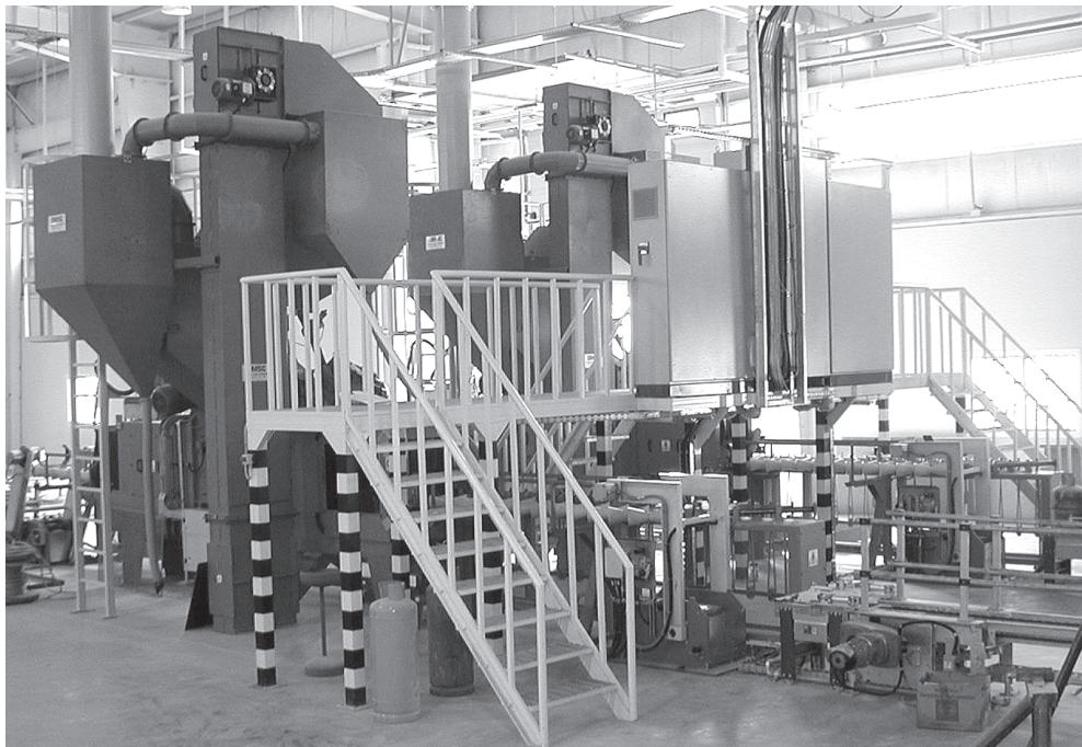
Рис. 1. Оборудование для дробеструйной обработки с автоматической загрузкой и выгрузкой баллонов
