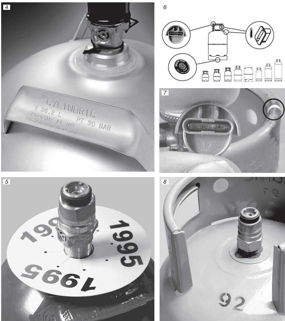
Рис. 2. Примеры маркировки: 4 — гравировка на ручке баллона; 5 — пластиковый диск вокруг клапана баллона; 6, 7 — тегирование баллона электронным носителем информации; 8 — окраска баллончиком через трафарет
